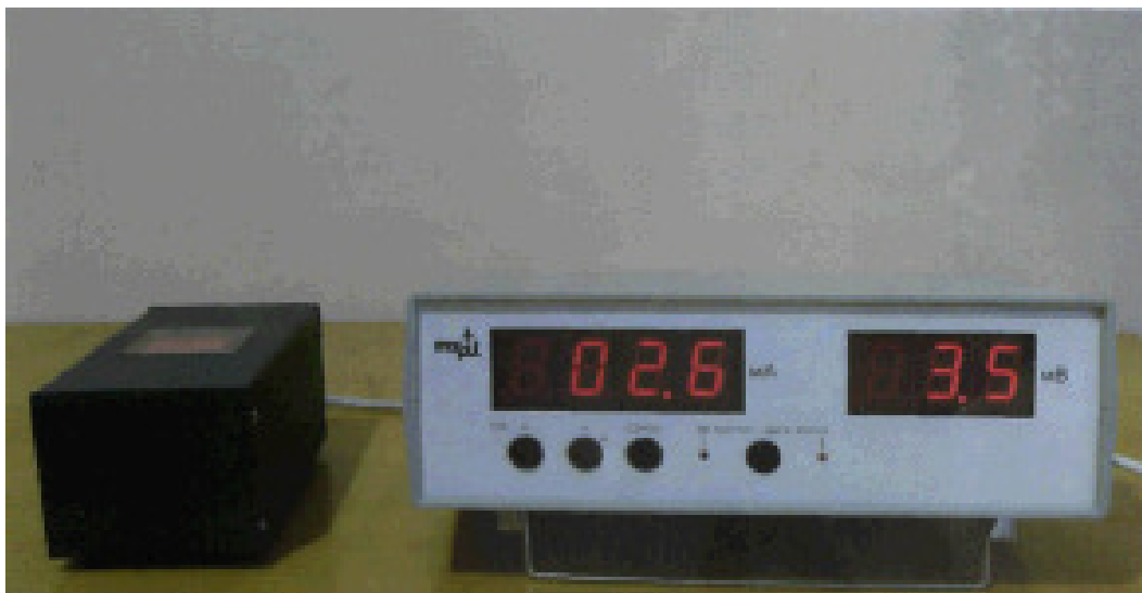
Рис. 3. Установка для изучения эффекта Холла в полупроводниках
