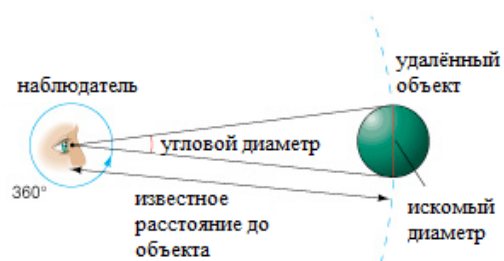
Рисунок 1.3 Определение линейных размеров удалённого объекта
