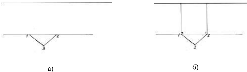
Рис. 75. Определение высоты призмы и построение грани боковой поверхности
