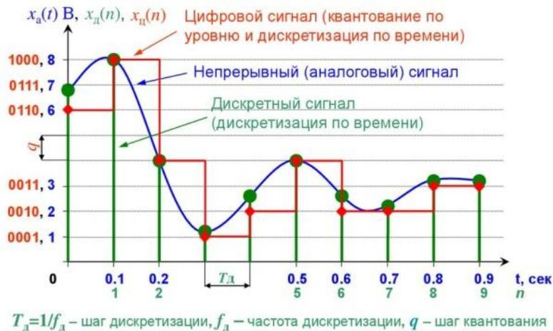
Рис. 5. Непрерывные и дискретные сигналы времени
