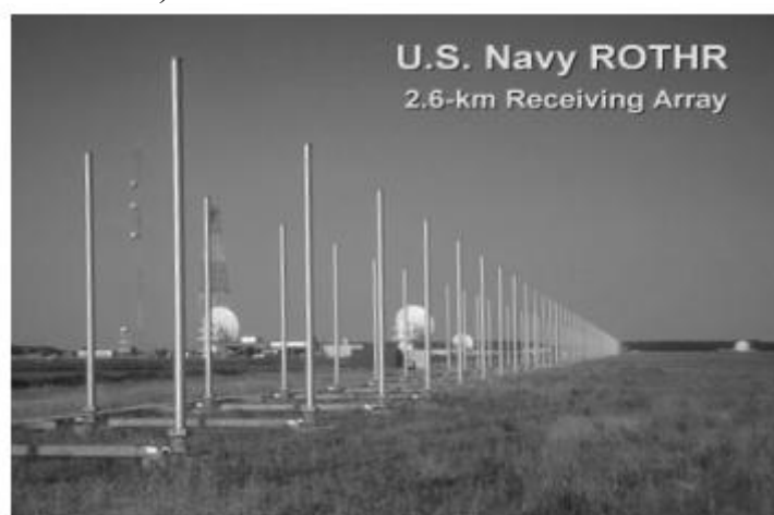
Рис. 2. Загоризонтная радиолокационная станция U.S. Navy Relocatable Over The Horizon Radar (ROTHR), работающая на частоте 5-28 МГц.
