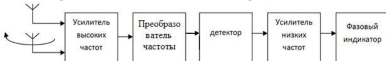
Рис. 36. Упрощенная блок – схема доплеровского пеленгатора.
