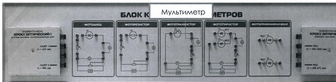
Рис. 11. Подключение мультиметра для снятия вольт-амперной характеристики фототранзистора.
