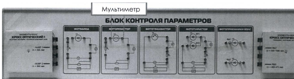
Рис.10. Подключение мультиметра для снятия люкс-омической характеристики.
