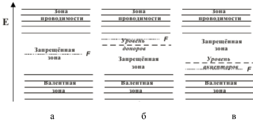
Рис. 3. Зонная структура полупроводников: а – собственный полупроводник, б – полупроводник n-типа, в – полупроводник p-типа. F – уровень Ферми.
