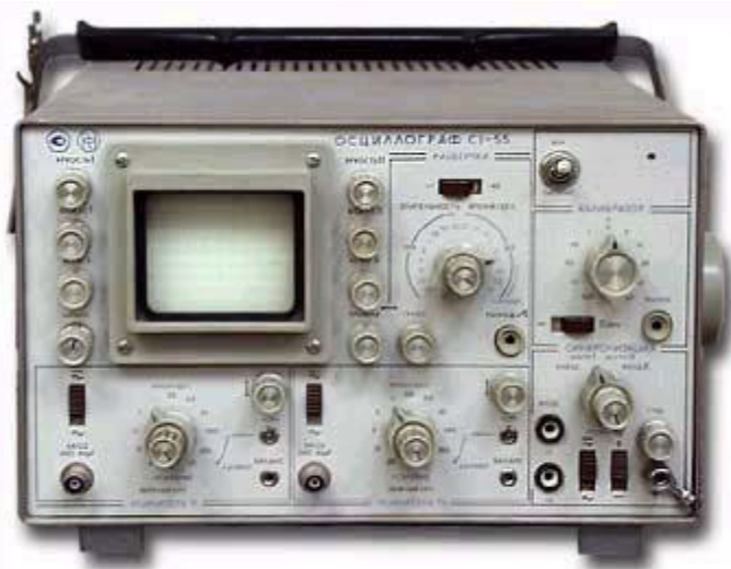
Рис. 3.1. Внешний вид осциллографа С1-55
