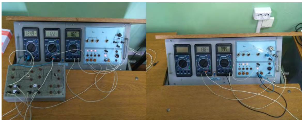
Рис. 38. Сборка электрической цепи на стенде «Уралочка»
