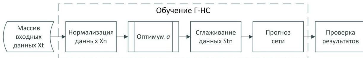
Рис 1. Схема обучения гибридной нейросети со сглаживанием, [X_t] – входные необработанные данные; t – время (дни), t_0=0 ; [X_{tn}] – данные, прошедшие нормализацию; a – оптимум; [S_{tn}] – массив данных после экспоненциального сглаживания
