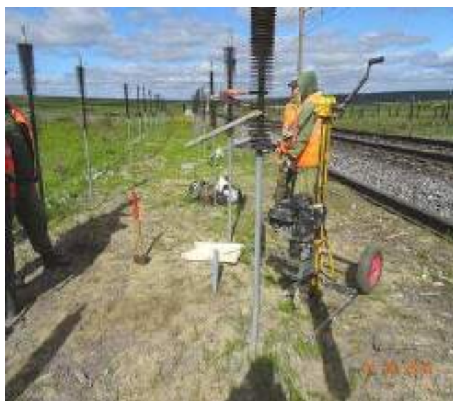
Рис. 2. Термометрические косы на перегоне Песец-Хановой, 2226 км
