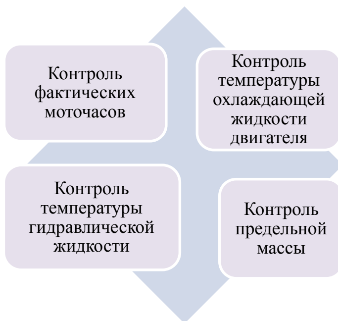
Рис. 2. Направления мониторинга строительных машин
