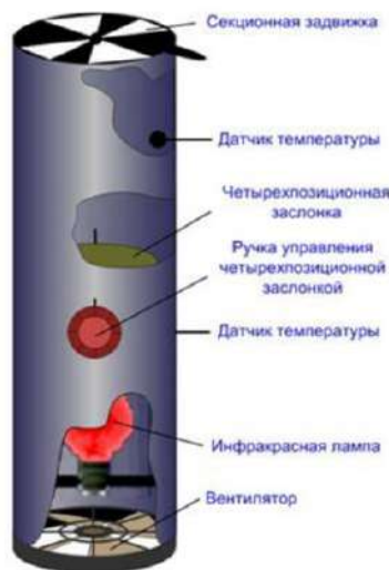
Рис. 2. Условная схема металлической трубы учебного стенда
