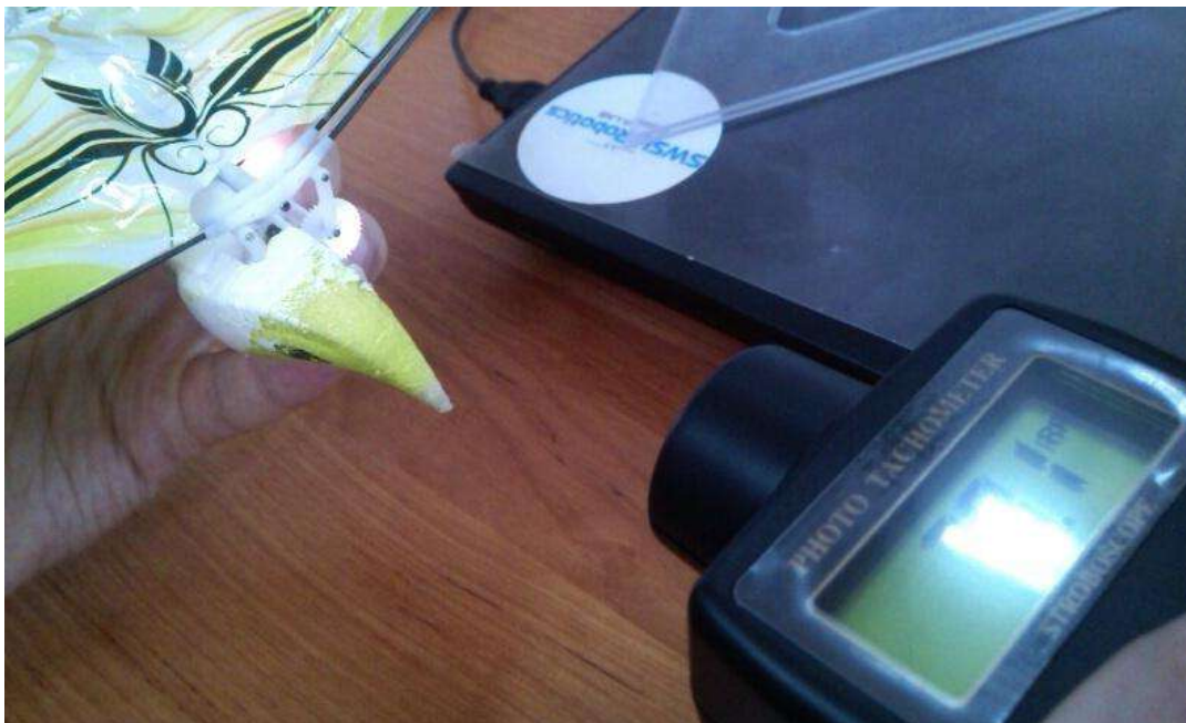
Рисунок 63. Засветка края шестерни световым лучом тахометром АКТАКОМ АТТ-6002
