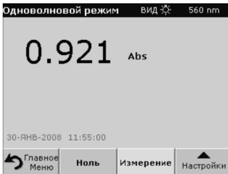
Рис. 15. Вид меню в режиме «Одноволновой режим» по окончании однократного измерения.
