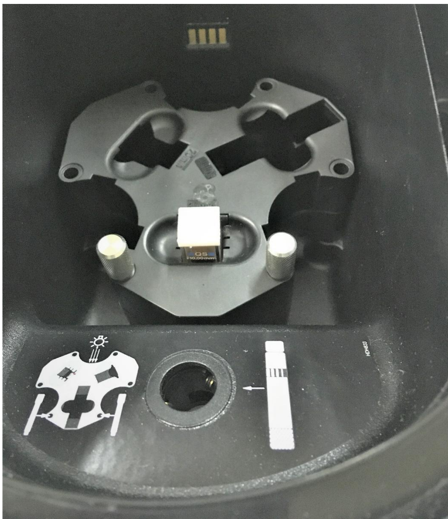
Рис 3. Отделение для кювет в спектрофотометре DR 5000 с установленной 10 мм квадратной кюветой
