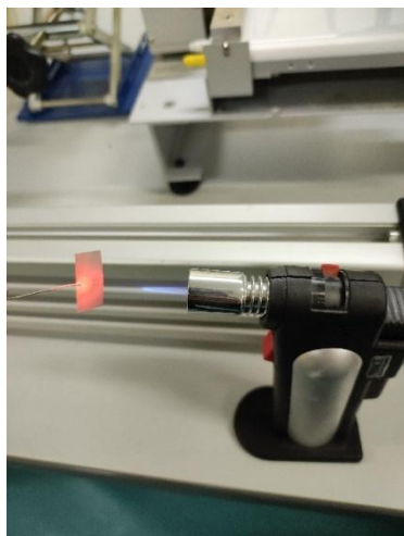
Рис. 7. Обжиг платиновой пластины
