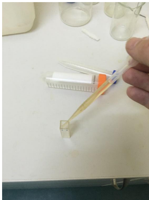
Рис. 10. Заполните прозрачную кювету 10 мм исследуемым раствором
