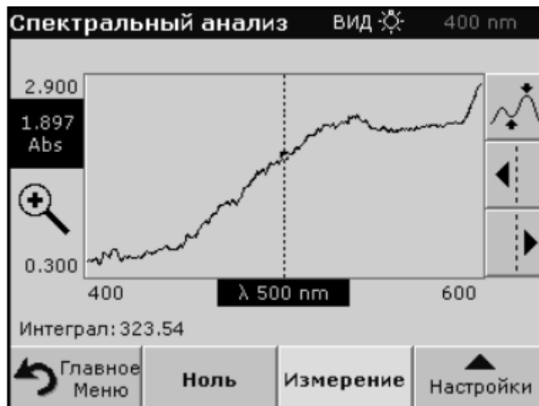
Рис. 11. Вид экранного меню в режиме «Спектральный анализ» после завершения сканирования. Вид графика может отличаться от представленного на рисунке
