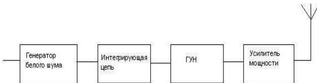
Рис. 1 – Структурная схема блокиратора GSM
